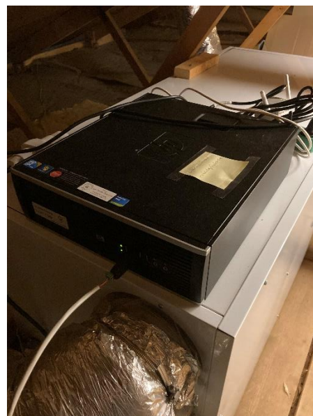
FIGUR 1 EN UDTJENT KM PC ER BLEVET SAT OP SOM STYRINGSMEKANISME I BOLIG 1
